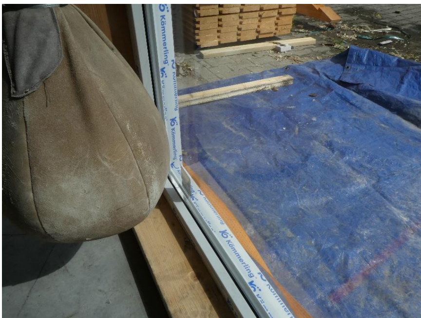
Foto 6 - test 2; na de test, aanstootpunt van glasparelzak. Geen visuele beschadigingen aan de glasruit waar te nemen.
