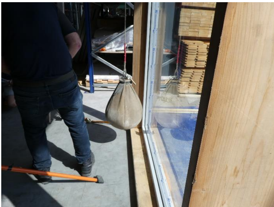
Foto 4 – test 1; na de test, aanstootpunt van glasparezak. Geen visuele beschadigingen aan de glasruit waar te nemen.
