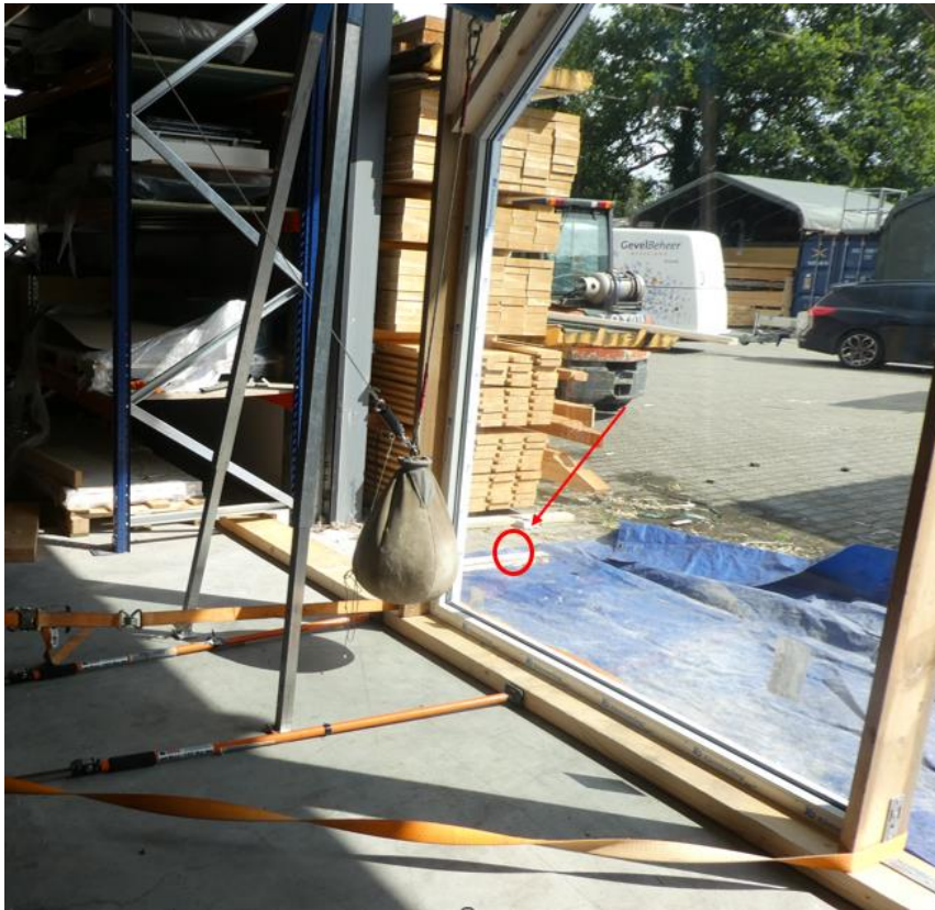
Foto 5 – test 2; voor de test, detailfoto doorvalveilige glasruit met aanstootpunt voor glasparelzak
