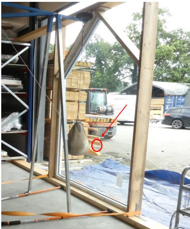
Foto 2 – test 1; glasparelzak op aanstootpunt, zie rode cirkel, ingemeten positie zie paragraaf 3.2 aanstootpunt voor glasparelzak
